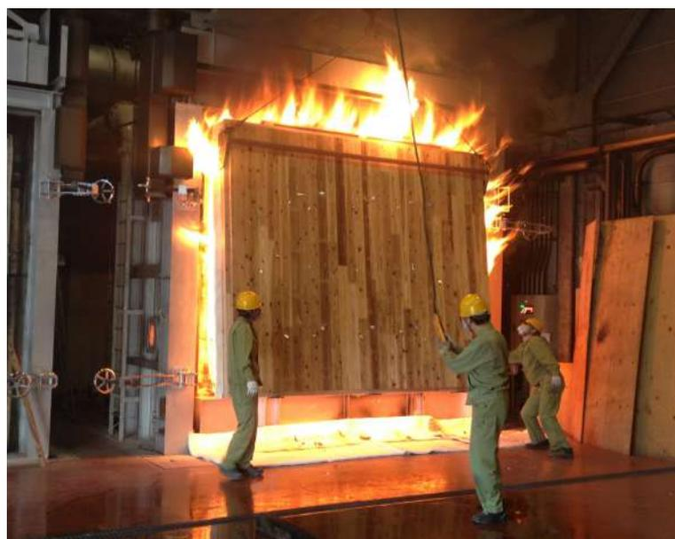
CLT壁の加熱実験の様子
